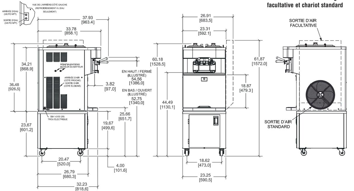
LES CHIFFRES ENTRE CROCHETS SONT EN MILLIMÈTRES. LES DIMENSIONS DÉCIMALES SONT ÉGALES À (PLUS OU MOINS) 1/16 POUCE [1,5 mm].
